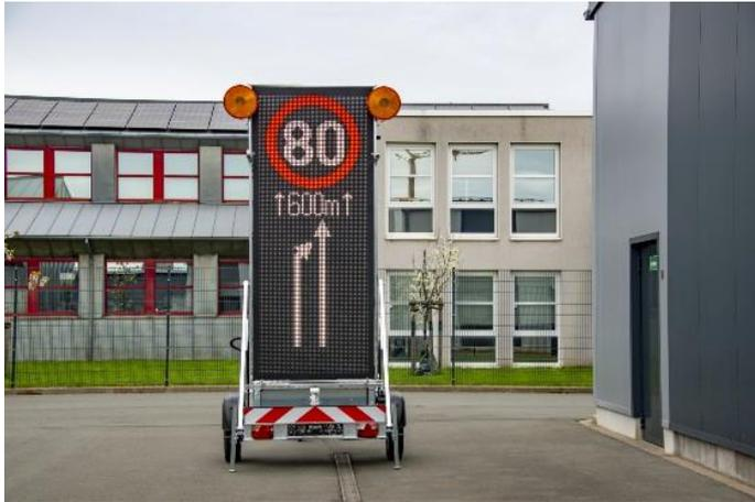
*Bildunterschrift: Das SingleBoard ist lichttechnisch geprüft gemäß EN 12966.*
