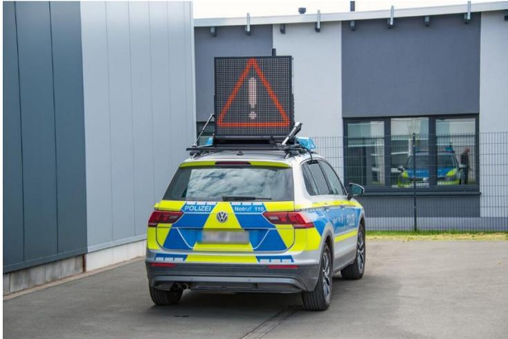
*Bildunterschrift: Das PoVIS 130 kann während der Fahrt aufgerichtet und auch wieder eingeklappt werden – und das bei einer Geschwindigkeit von bis zu 130 km/h.*
