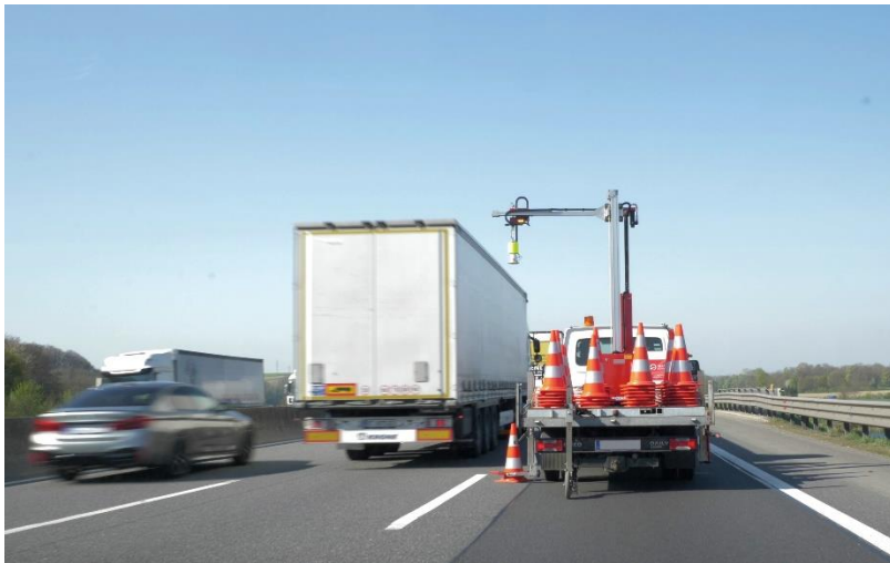
Bildunterschrift: Das X-Cone Leitkegelmanagement-System sorgt für mehr Sicherheit, weil sich kein Mitarbeiter auf der Ladefläche des Fahrzeugs aufhalten muss.
