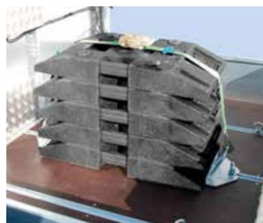
Die Module können individuell befestigt, entfernt, neu positioniert und kombiniert werden. Fahrbare Absperranzeiger von horizont werden somit zum Transportanhänger für jeden Einsatz im Straßenbetriebsdienst.
