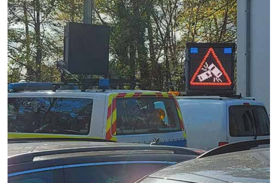
Vergleich: Links: handelsübliches Pol-/Feu-Vis. Rechts: Drehbares „Vision360°“.
